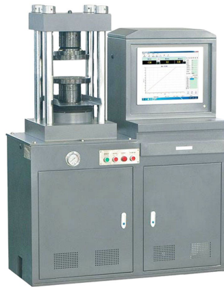
Figur 1. Exempel på utrustning för inmätning av egenskaper för mognad och hållfasthet – temperaturreglerat vattenbad med hårdnande betongkuber (vänster) samt maskin för provtryckning av betongkuber och mätning av tryckhållfasthet (höger)
